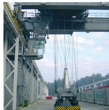
Federleitungstrommel Stock&Go auf einem Spreader
